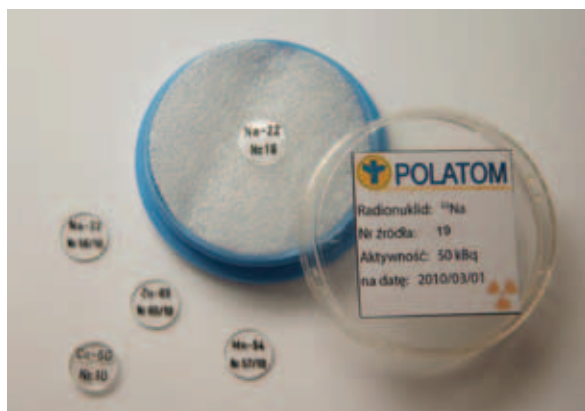
Źródło punktowe \gamma w obudowie z pleksi
