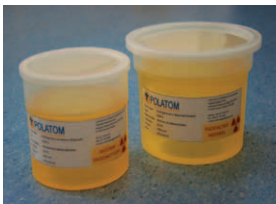
Objętościowe źródła multigamma w żywicy epoksydowej
